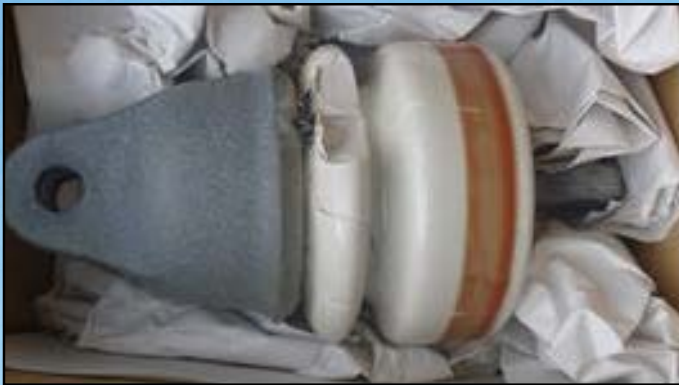
図6 亀裂を生じた碍子
